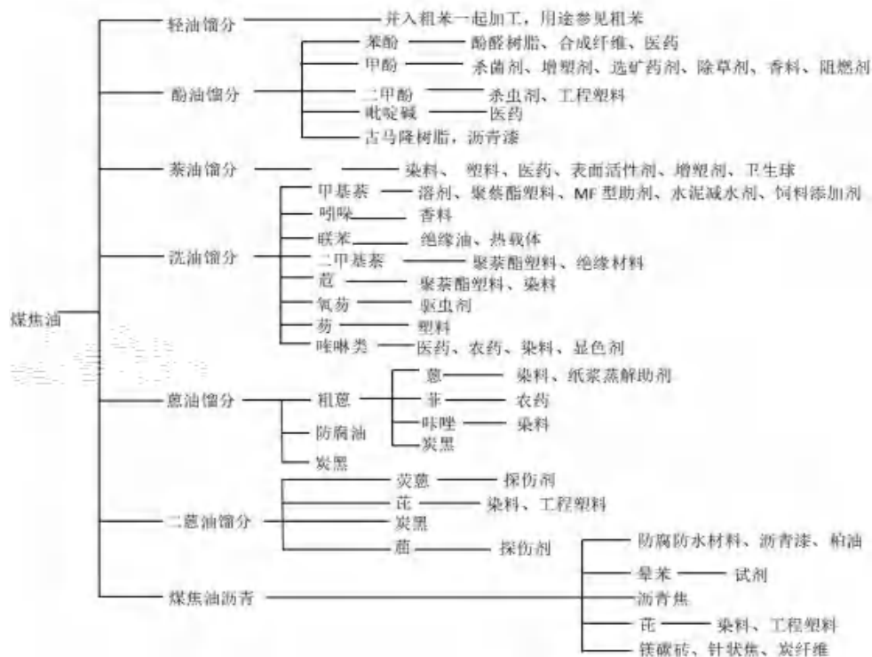
图 19 煤焦油下游产品路线图
