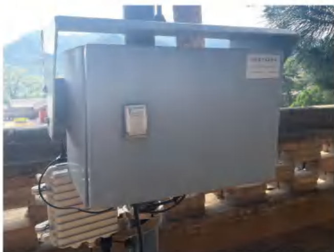
佛光寺无线微气象监测仪
